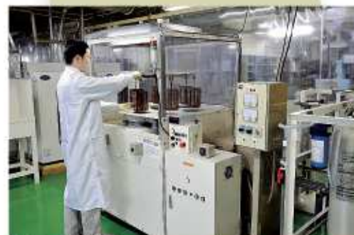
電着クロードシステム Electrodeposition closed system
